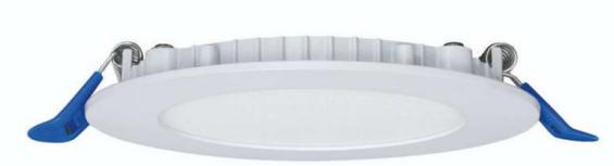
Luminario led tipo downlight ultradelgado para empotrar en plafón con lámpara tipo SMD y driver incluido; cuerpo circular fabricado en aluminio con acabado color blanco. Con switch de tres posiciones para seleccionar la temperatura de color entre blanco cálido, blanco neutro y blanco frío.
